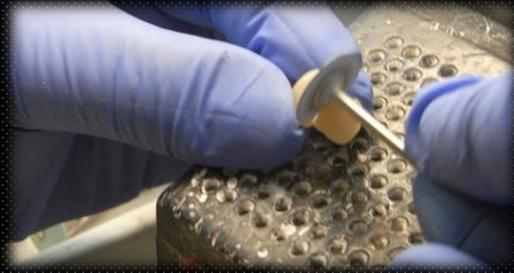
Después de la sinterización, acabar con discos y fesadoras diamantadas, utilizando una turbina enfriada con agua para evitar de recalentar la pieza.
