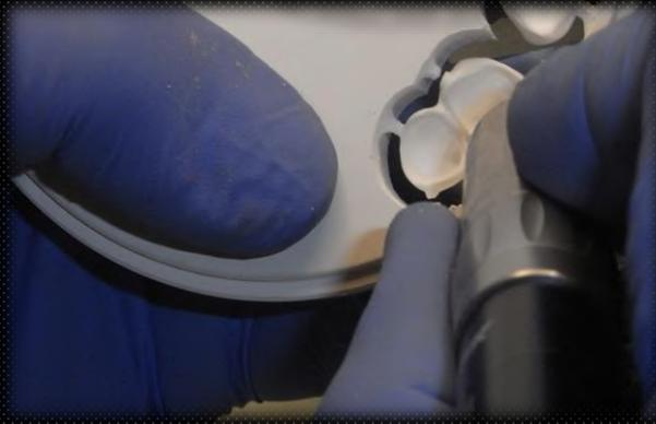
**Eliminación de la estructura fresada del bloque.**
