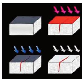
del tipo fluorescente con una capacità di penetrazione molto elevata tale da insinuarsi nelle fenditure più sottili. La diffusione per capillarità consente la propagazione in ogni punto, anche di difficile accesso, laddove ci sia una discontinuità superficiale.
